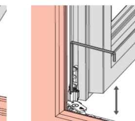
**SE:** När karmen är korrekt monterad, kan ytterligare justeringar görs på beslag i karm och båge.
