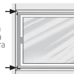
**SE:** Kontrollera att spalten mellan karm och båge är lika stor över hela vägen runt. Justera karmen om nödvändigt. Ta bort tillfälliga kilar.
